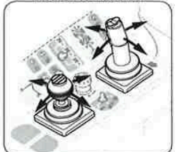
DE STAAT VAN DE MANIPULATORBALGEN CONTROLEREN
